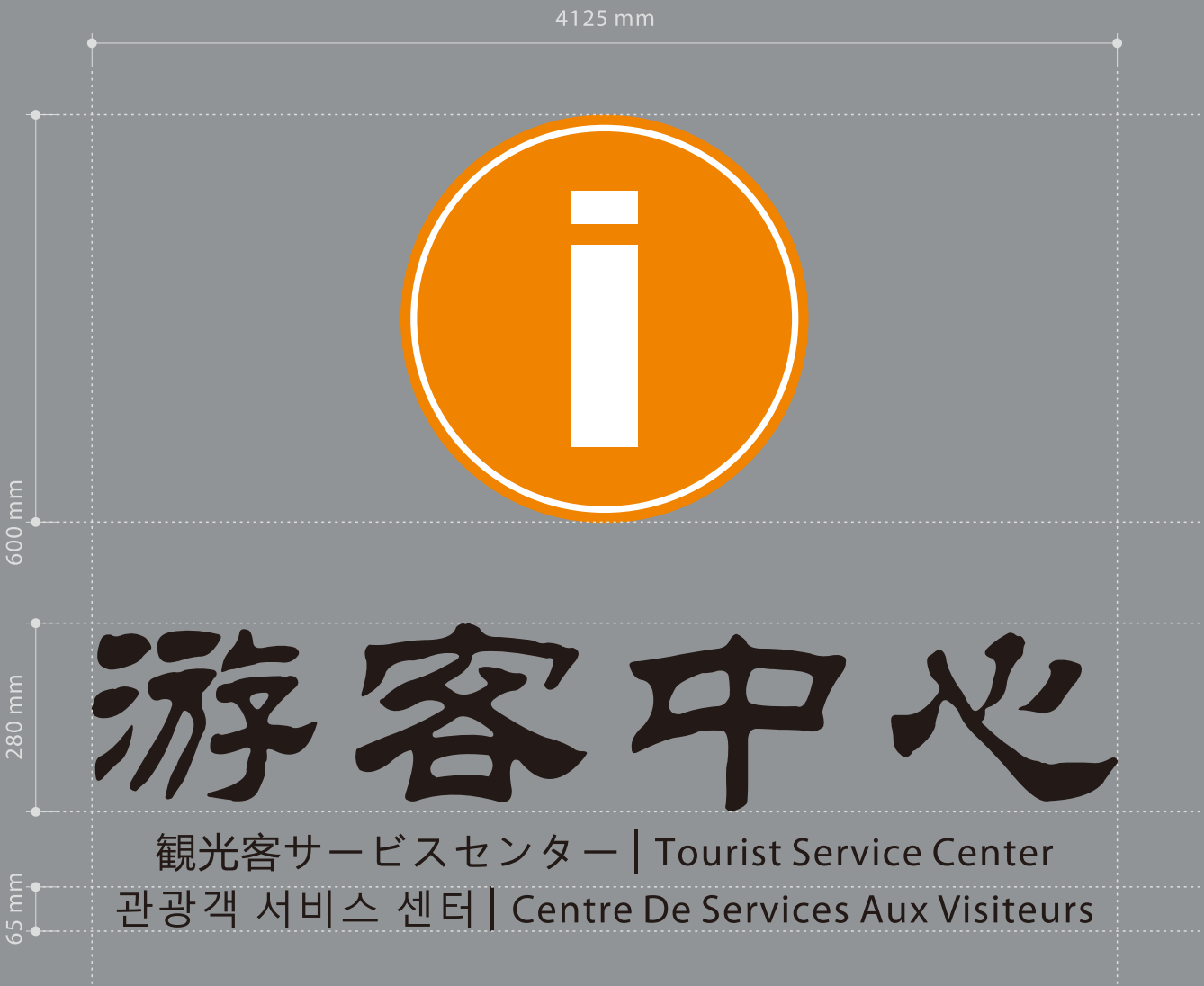
1.5mm不锈钢创槽折弯围边立体字，烤漆
