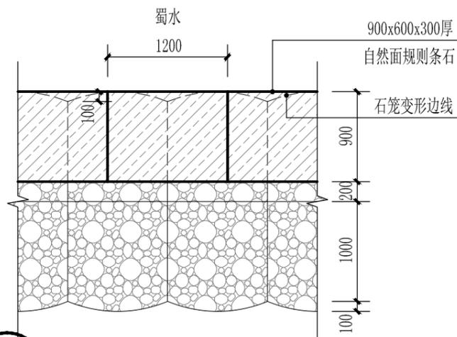
① 一级挡墙变更标准段平面图 1:50
